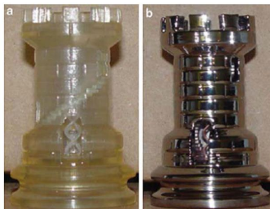
Slika 18. Predmet izrađen stereolitografijom a) prije kromiranja b) nakon postupka kromiranja [1]
