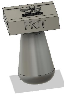
Slika 12. Primjer modela žiga u Fusion 360 programu
