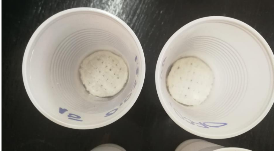
Slika 8. Mrežice s imobiliziranim \text{TiO}_2
