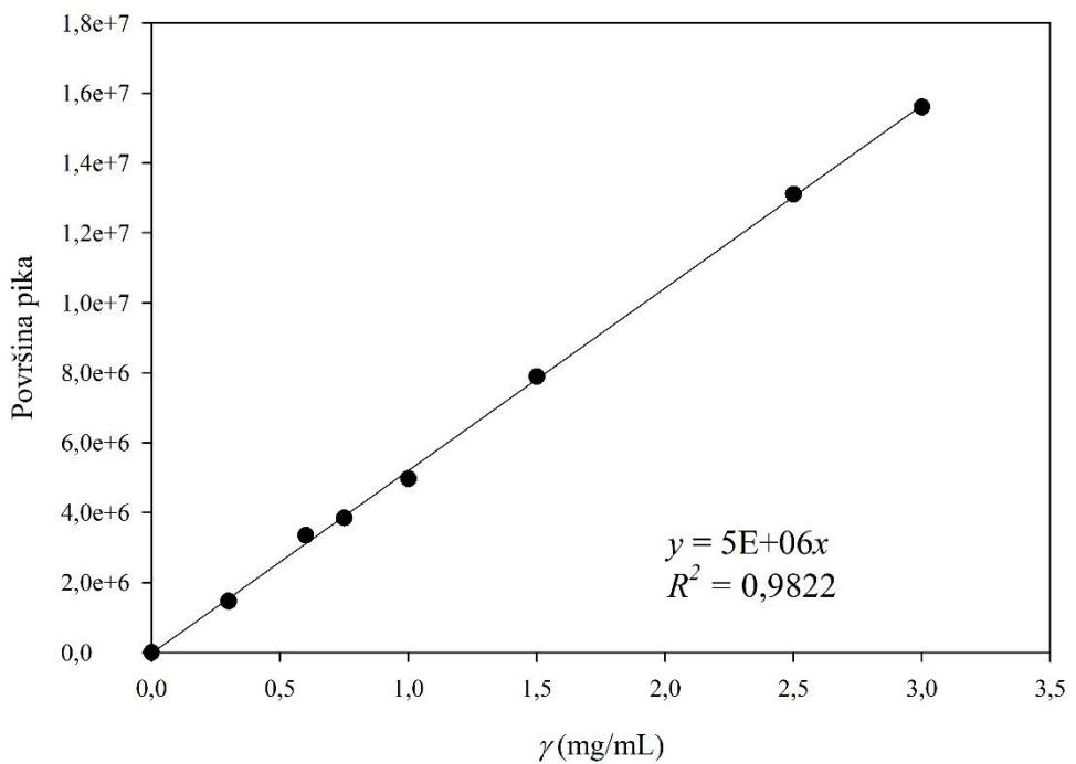
Prilog 2. Baždarni dijagram za određivanje koncentracije glicerola na plinskom kromatografu
