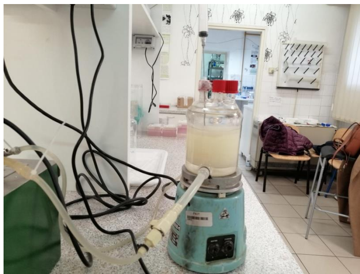
Slika 4. Uzimanje uzorka iz šaržnog reaktora
