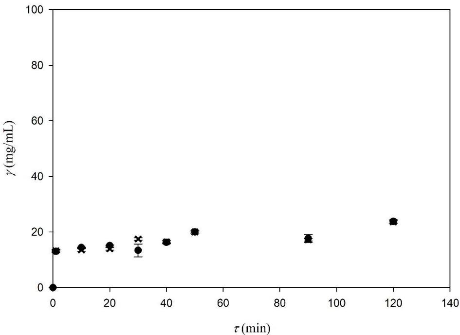
Slika 14. *On-line* mjerjenje koncentracije glicerola NIR spektroskopijom tijekom reakcije transesterifikacije provedene u mikroreaktoru (● – izračunati, teorijski glicerol, x – NIR spektroskopija)
