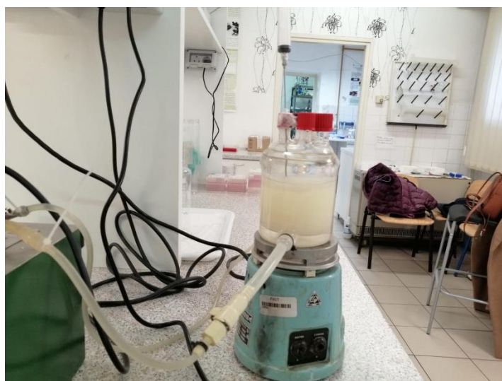
Slika 4. Uzimanje uzorka iz šaržnog reaktora
