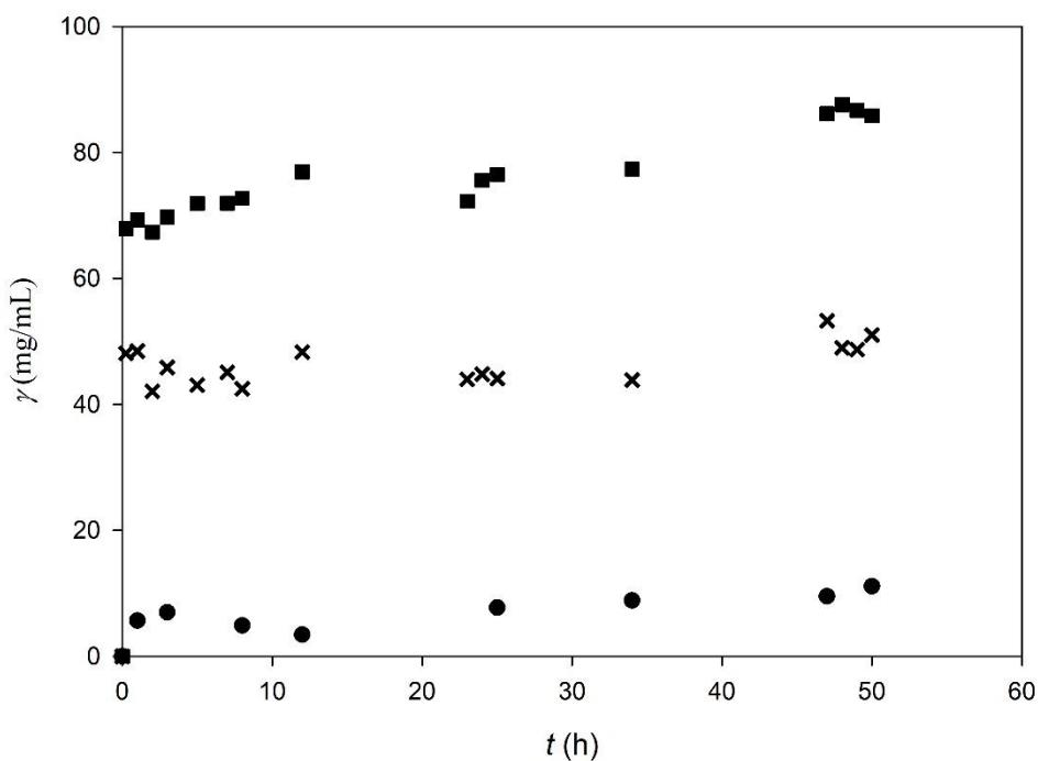
Slika 8. Usporedba analitičkih metoda za mjerjenje koncentracije glicerola s izračunatim, teorijskim vrijednostima (■ – izračunati, teorijski glicerol, x – plinska kromatografija, ● – spektrofotometrija)
