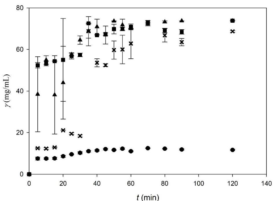
Slika 12. Usporedba analitičkih metoda za mjerjenje koncentracije glicerola s izračunatim, teorijskim vrijednostima (■ – izračunati, teorijski glicerol, x – plinska kromatografija, ● – spektrofotometrija, ▲ – NIR spektroskopija)
