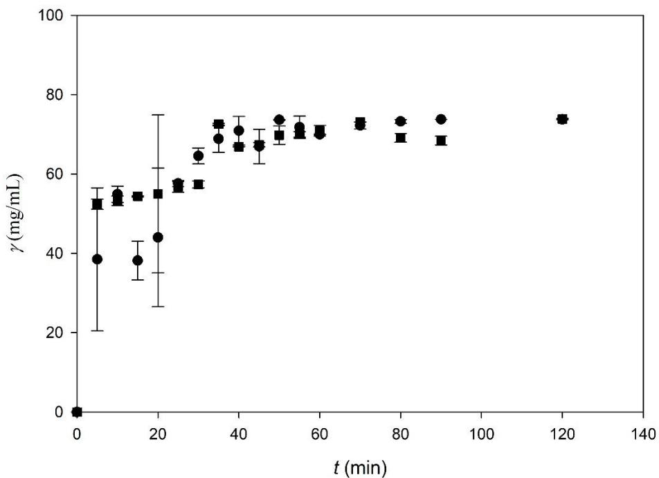
Slika 13. *On-line* mjerjenje koncentracije glicerola NIR spektroskopijom tijekom reakcije transesterifikacije provedene u kotlastom reaktoru (■ – izračunati, teorijski glicerol, ● – NIR spektroskopija)
