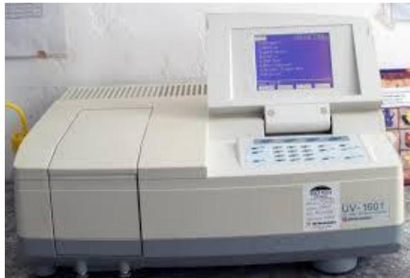
Slika 6. Spektrofotometar
