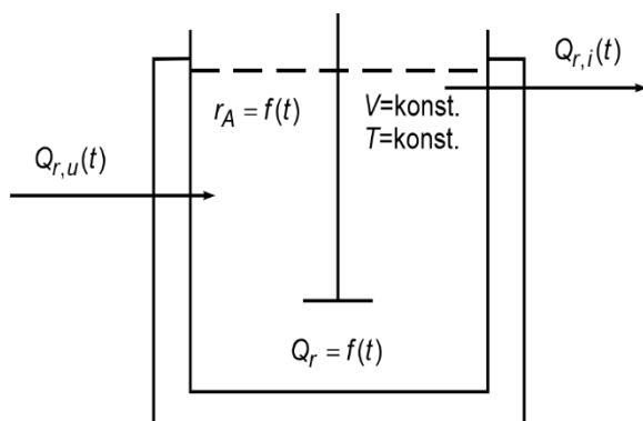
Slika 2. Shema idealnog kotlastog reaktora
