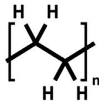
Slika 7. Strukturna formula monomera polietilena [1]
