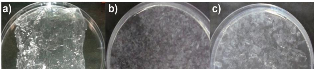
Slika 33. Inkubirani PVC film (a), sa P. citronellolis (b) i B. flexus (c) nakon 70 dana.[61]
