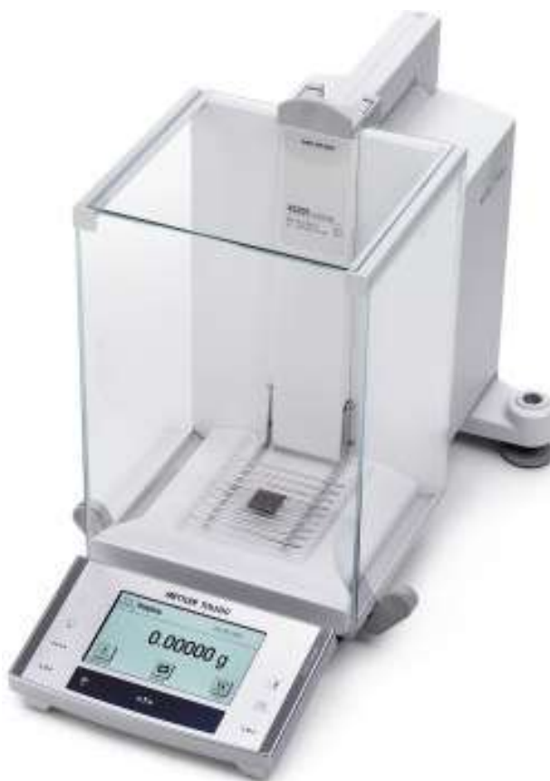
Slika 7. Analitička vaga XS204 Delta Range, Mettler Toledo
