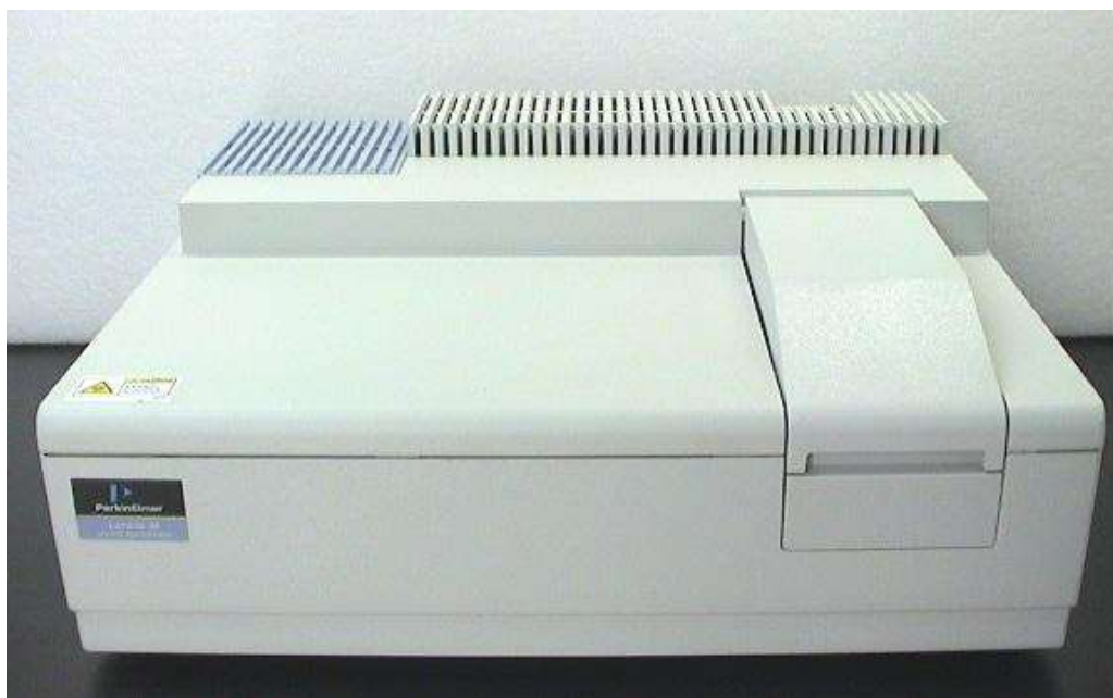
Slika 8. Spektrofotometar PerkinElmer Lambda 35
