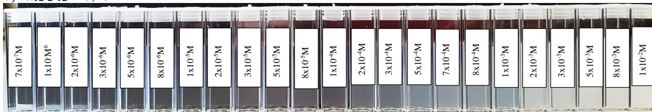
Slika 15. Fotografije smjesa 12-2-12/AOT s velikim ( \alpha_{12-2-12} = 0,10 ) i malim ( \alpha_{12-2-12} = 0,25 ) suviškom AOT. Uzorci su stari 24 h pri temperaturi 25 °C.
