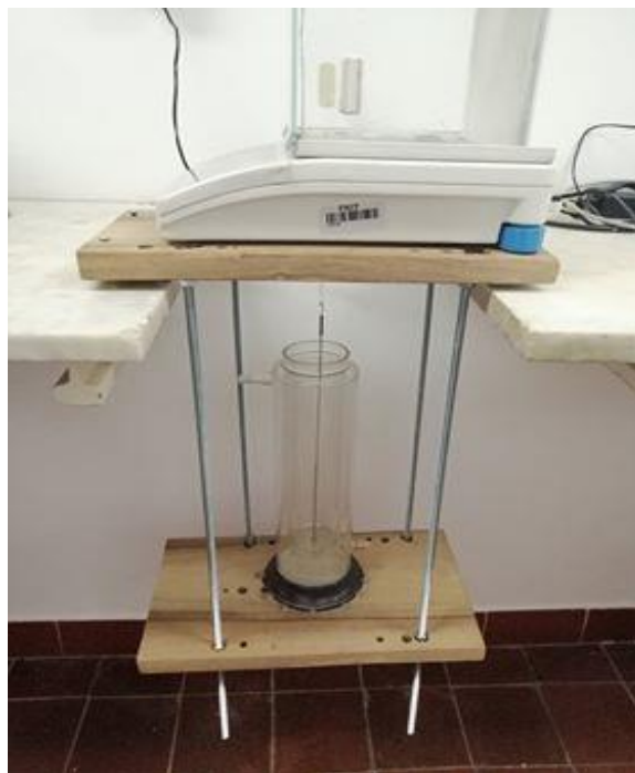
Slika 13: Prikaz aparature za mjerenje raspodjele veličine čestica
