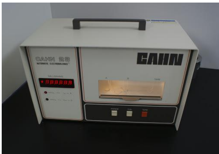
Slika 4: Cahn C- microbalance uređaj
