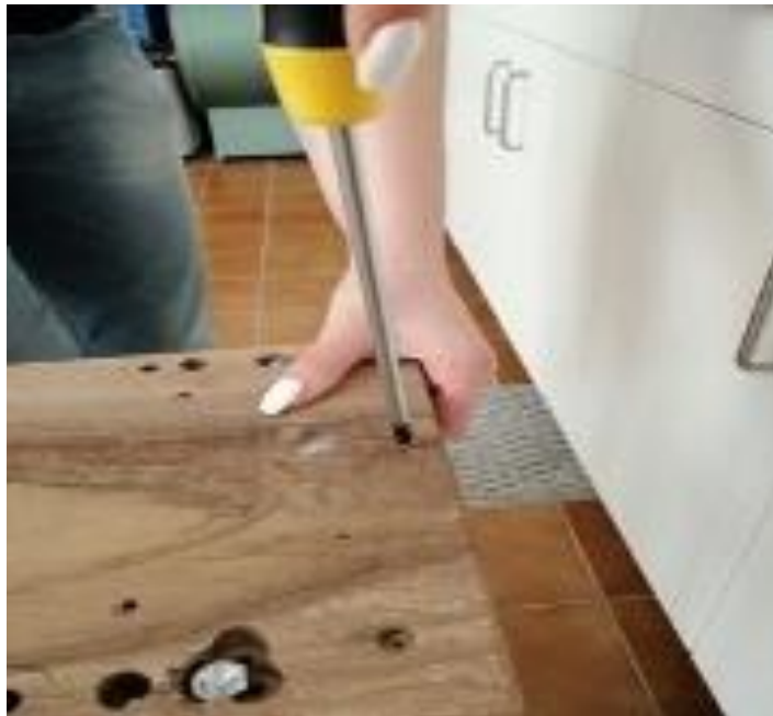
Slika 12: Postavljanje metalnih matica za fiksacijo drvenih podloga
