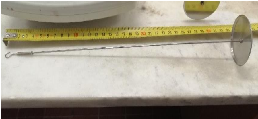
Slika 7: Prikaz metalnog tanjurića sa zadanim dimenzijama
