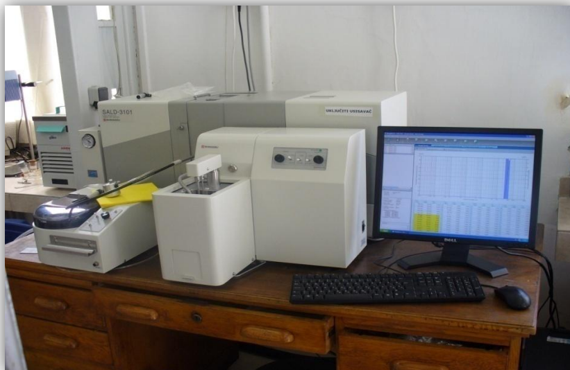
Slika 3.7. Fotografija uređaja za određivanje raspodjele veličina čestica metodom laserske difrakcije SALD-3101 (Shimadzu, Kyoto, Japan).
