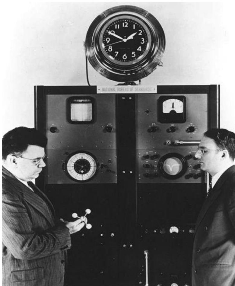
Slika 12. Atomski sat s amonijevim maserom[18]
