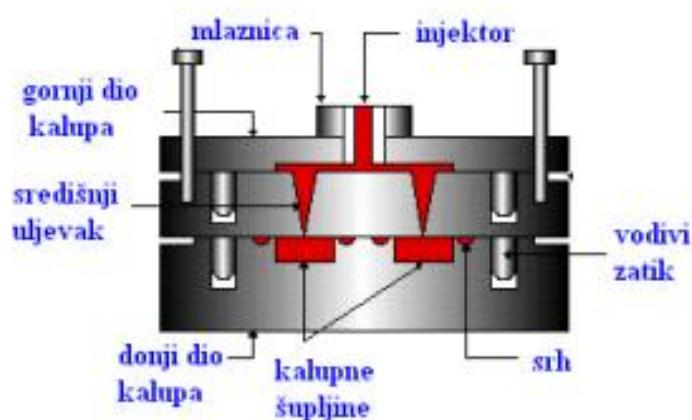
Slika 2.15. Shematski prikaz kalupa za posredno (transfer) prešanje<sup>[27]</sup>
