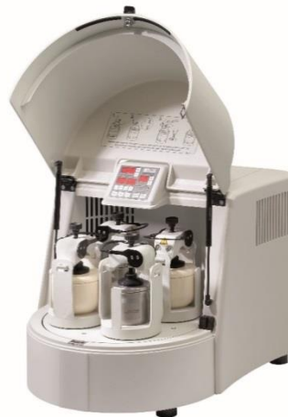
Slika 2.7. Planetarni kuglični mlin za mljevenje, Pulverisette 5 [25]
