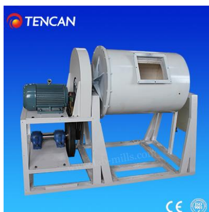
Slika 2.8. Rotacijski kuglični mlin za mljevenje, TENCAN QM-50L [25]
