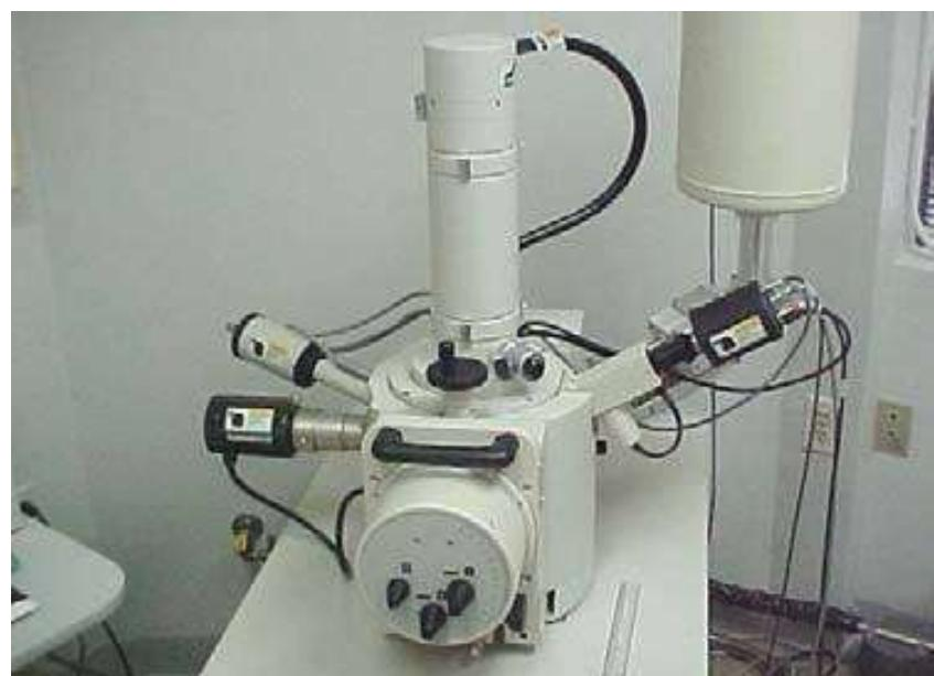
**Slika 15.** SEM uređaj s karakterističnim detektorima
