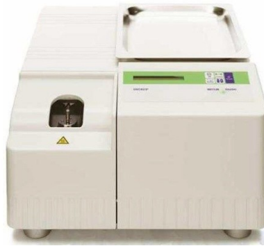
Slika 20. Diferencijalni pretražni kalorimetar, Mettler Toledo DSC 823e
