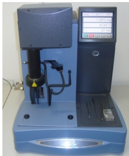
Slika 21. Termogravimetar, TA Instruments Q500
