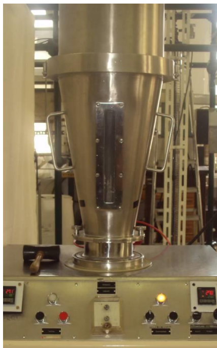
Slika 3.19. Granulator s fluidiziranim slojem Uni-Glatt (Glatt GmbH, Njemačka)
