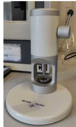
Slika 19. Preša za pripravu uzoraka
