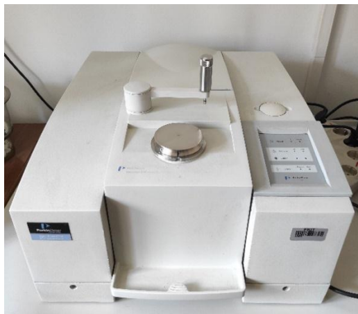
Slika 17. FT-IR spektrometar, Perkin Elmer Spectrum One Spectrometer
