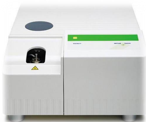
Slika 4.4. Fotografija diferencijalnog pretražnog kalorimetra Mettler Toledo 822e (Mettler Toledo GmbH, Greifensee, Švicarska)
