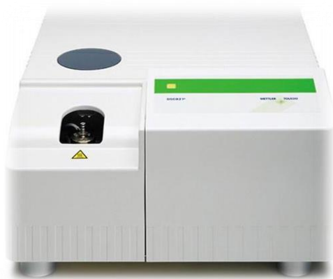
Slika 4.4. Fotografija diferencijalnog pretražnog kalorimetra Mettler Toledo 822e (Mettler Toledo GmbH, Greifensee, Švicarska)
