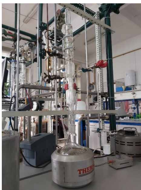
Slika 16. Aparatura za Soxhlet ekstrakciju
