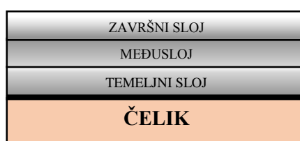
Slika 15. Shematski prikaz broskog premaza
