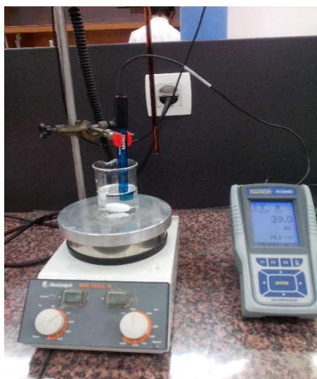
Slika 24. Određivanje koncentracije kloridnih iona pomoću OAKTON kloridne elektrode
