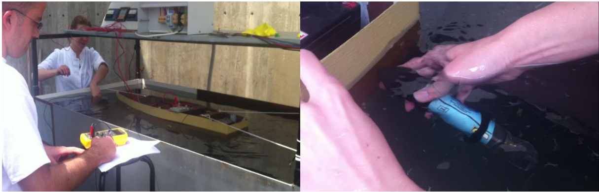
Slika 30. Mjerenje potencijala na oštećenjima pomoću Lugginove kapilare
