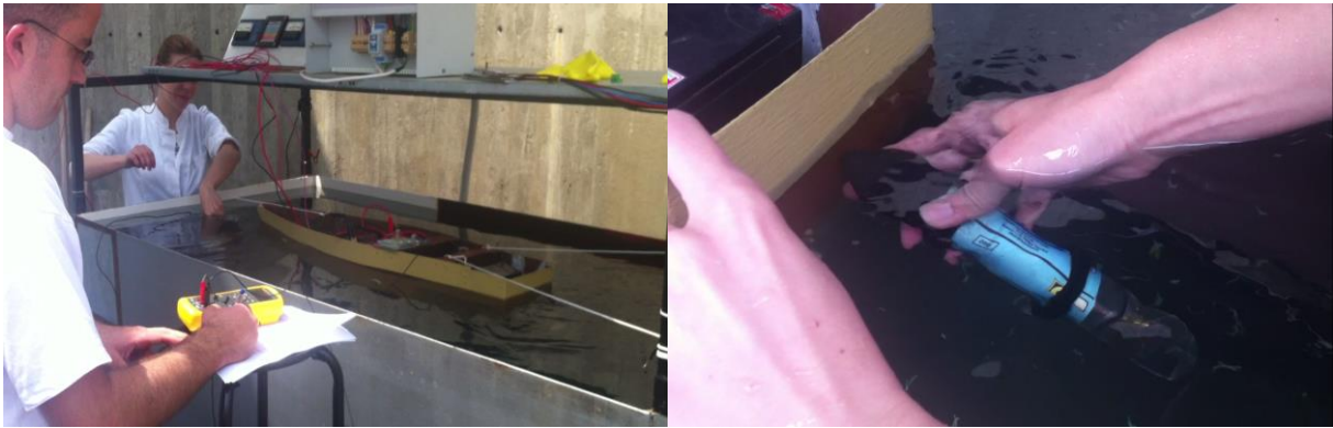
Slika 30. Mjerenje potencijala na oštećenjima pomoću Lugginove kapilare
