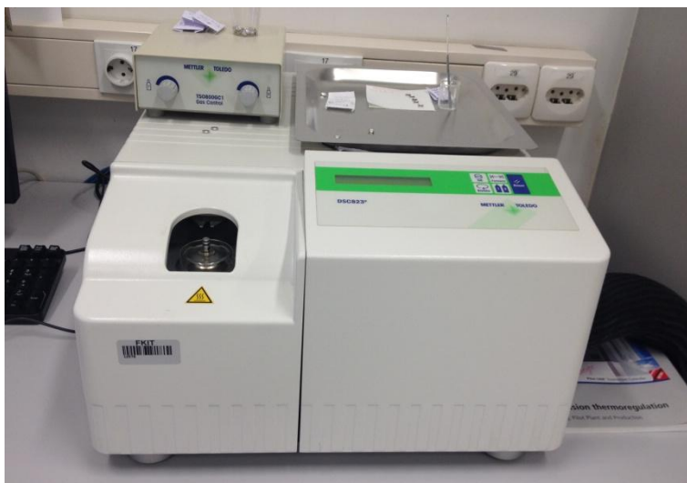
Slika 12. Diferencijalni pretražni kalorimetar Mettler Toledo DSC823°
