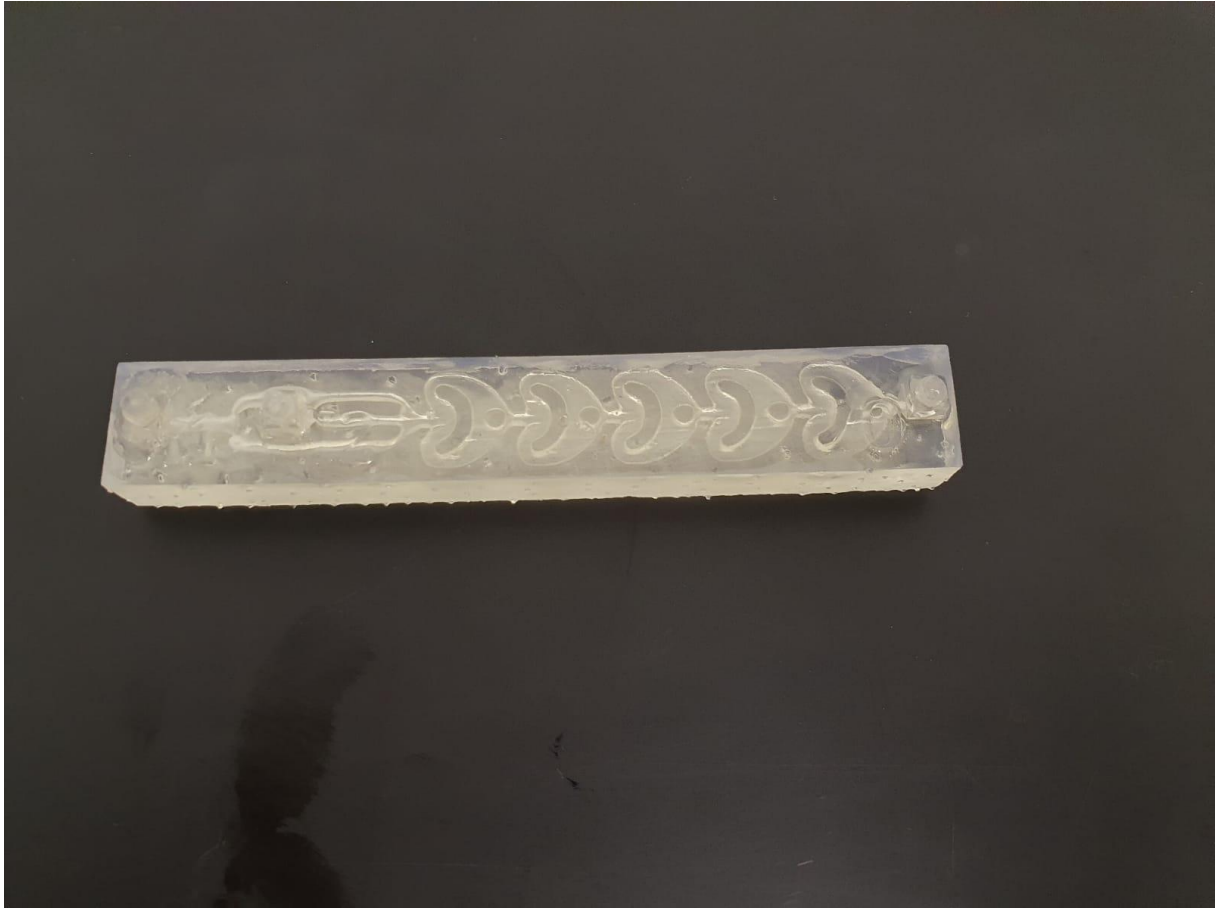
Slika 11. Izgled Milireaktora R1 nakon izlaganja Sunčevoj svjetlosti
