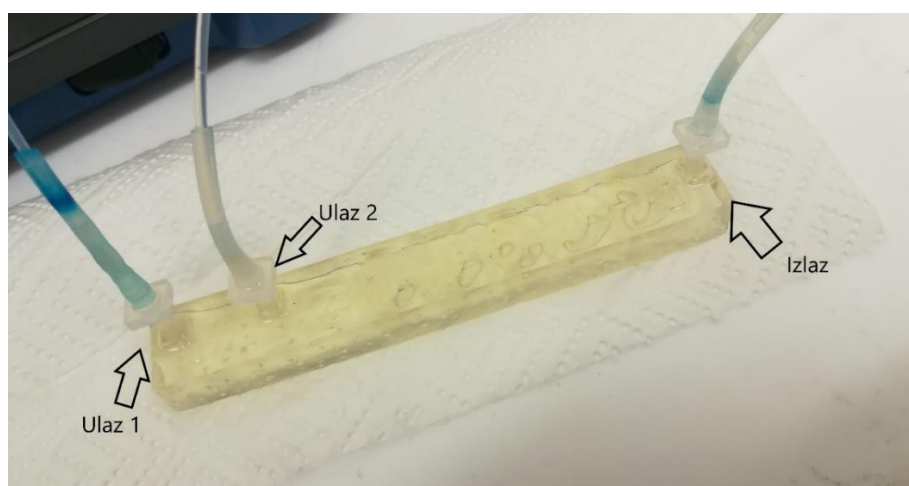
Slika 19. Izgled milireaktor prije stavljanja u vodenu kupelj
