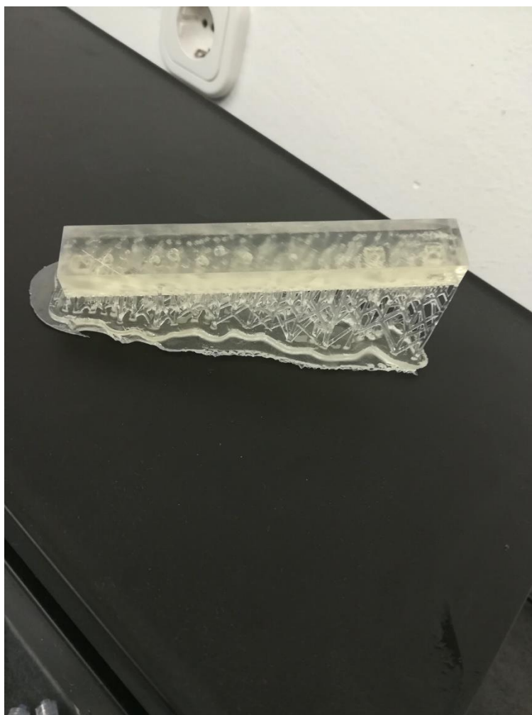
Slika 16. Milireaktor V2 s potpornim stupovima
