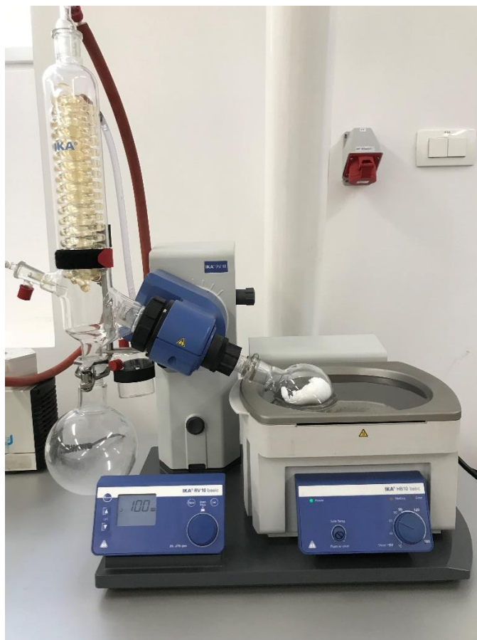
Slika 6. Miješanje i zagrijavanje otapala na uređaju IKA RV 10 Basic rotary evaporator .
