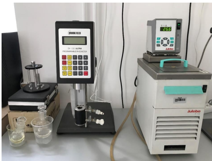
Slika 8. Rotacijski viskozimetar Brookfield DV-111 ULTRA te termostat F12 Julabo .
