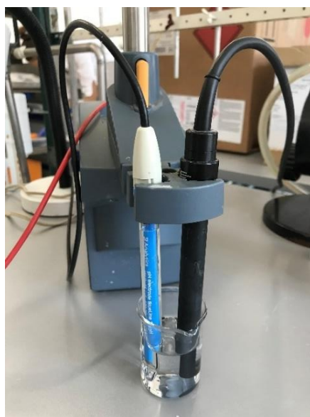
Slika 9. pH elektroda BlueLine (lijevo) i konduktometrijska elektroda WTW Tetracon 325 (desno).
