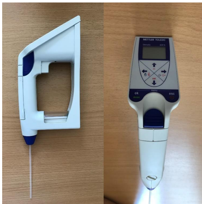
Slika 7. Uređaj za mjerenje gustoće Mettler Toledo Densitometer 30PX .
