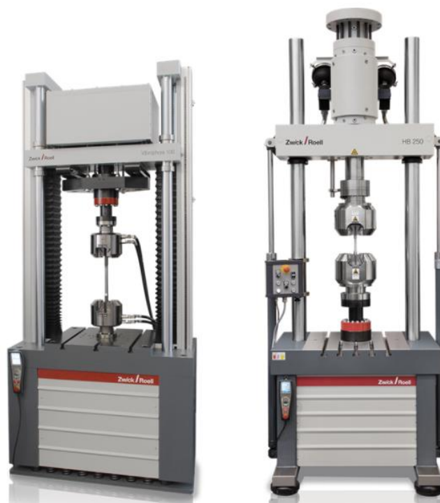
Slika 31. Prikaz mehaničke kidalice proizvođača Zwick Röell [24]
