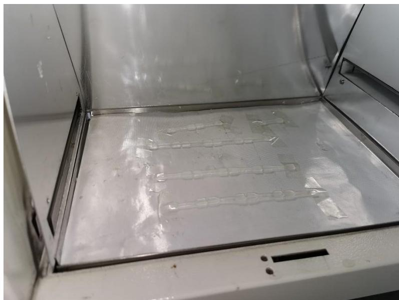
Slika 28. Unutrašnjost SunTest komore sa postavljenim epruvetama
