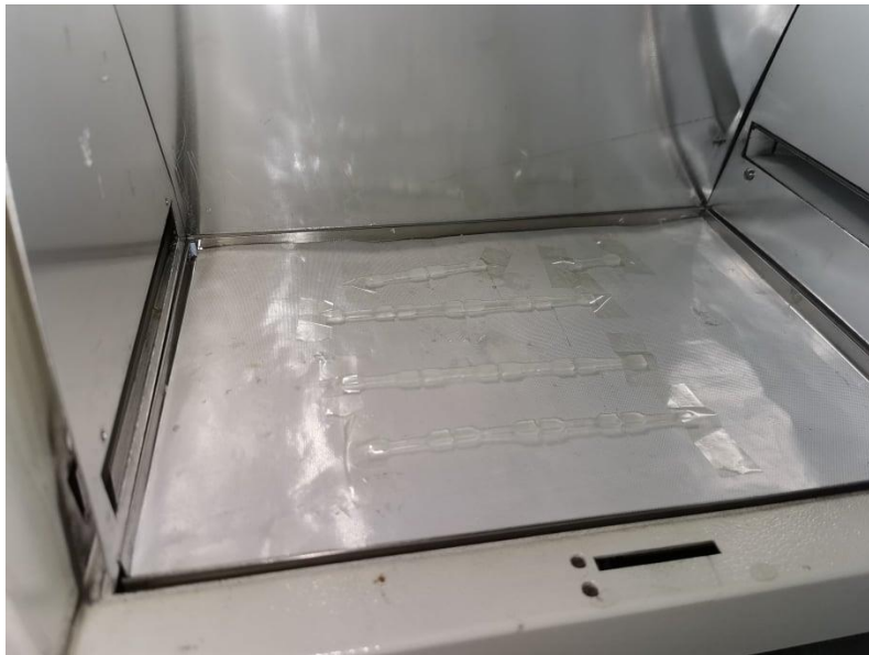
Slika 28. Unutrašnjost SunTest komore sa postavljenim epruvtama
