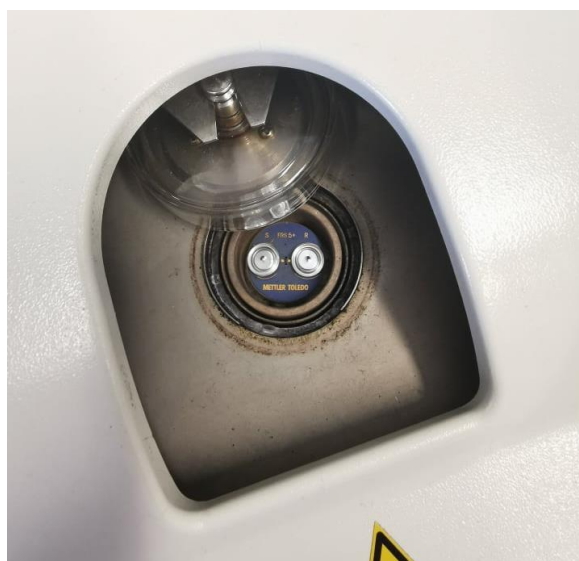
Slika 30. Dio uređaja za DSC gdje se postavlja mjerni uzorak
