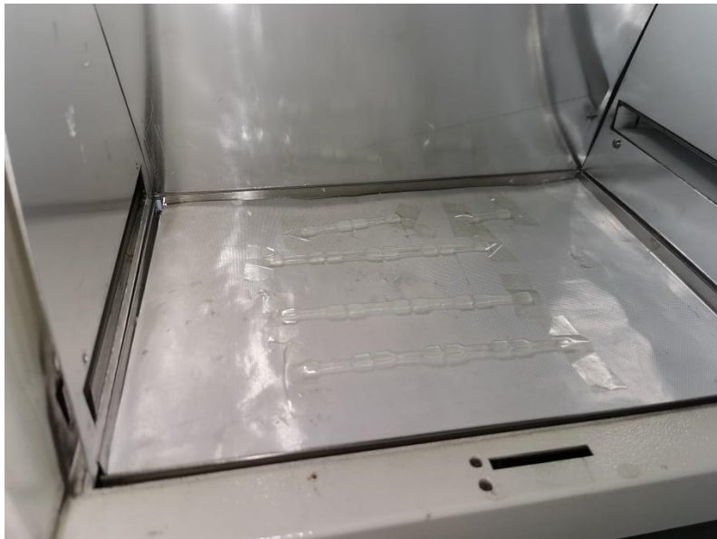
Slika 28. Unutrašnjost SunTest komore sa postavljenim epruvtama
