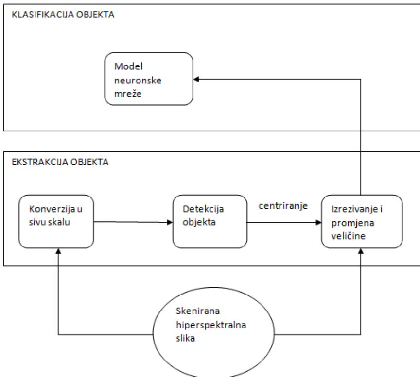
Slika 5. Dizajn sustava temeljenom na strojnog učenju za detekciju mikroplastike<sup>57</sup>
