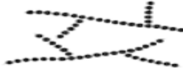
Slika 2. Shematski prikaz razgranate makromolekule [3]
