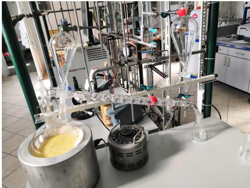
Slika 12. Aparatura za hidrodestilaciju
