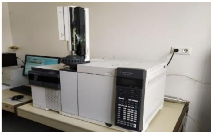
Slika 15. Plinski kromatograf sa spektrometrijom masa (GC-MS)
