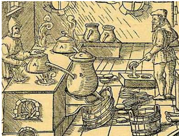
Slika 1. Dobivanje eteričnih ulja destilacijom u 10.stoljeću
