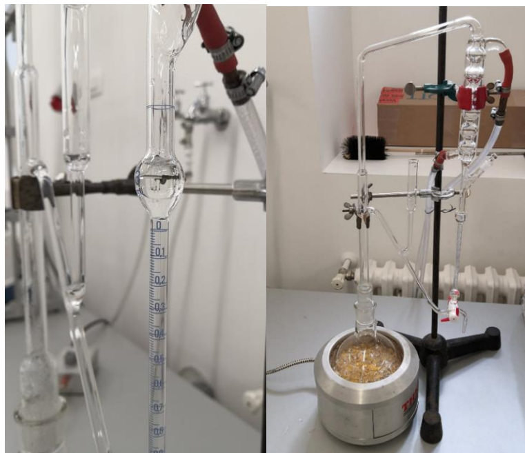
Slika 13. Aparatura za hidrodestilaciju po Clevengeru
