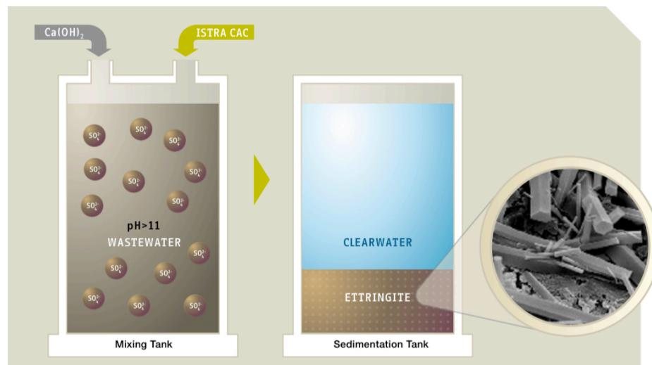
**Slika 23.** Shematski crtež čišćenja otpadnih voda s ISTRA CAC-om [24]
