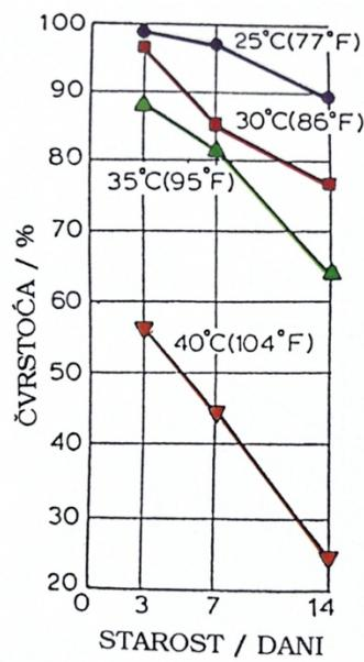
*Slika 8. Pad čvrstoće AC pri povišenim temperaturama [15]*
