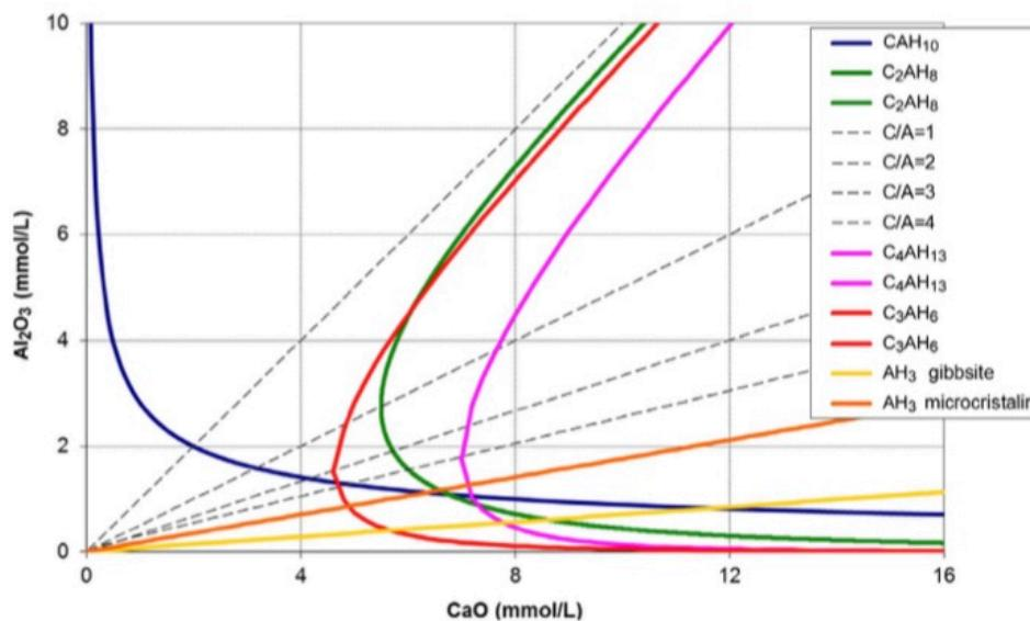
**Slika 15.** Krivulje topljivosti produkata hidratacije u sustavu  $\text{CaO}-\text{Al}_2\text{O}_3$  na 20 °C. Točkaste crte pokazuju razvoj otopine za različite omjere C / A ( $\text{CaO} / \text{Al}_2\text{O}_3$ ). [5]
