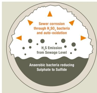
*Slika 27. Mehanizam biogene korozije sumporne kiseline [26]*
