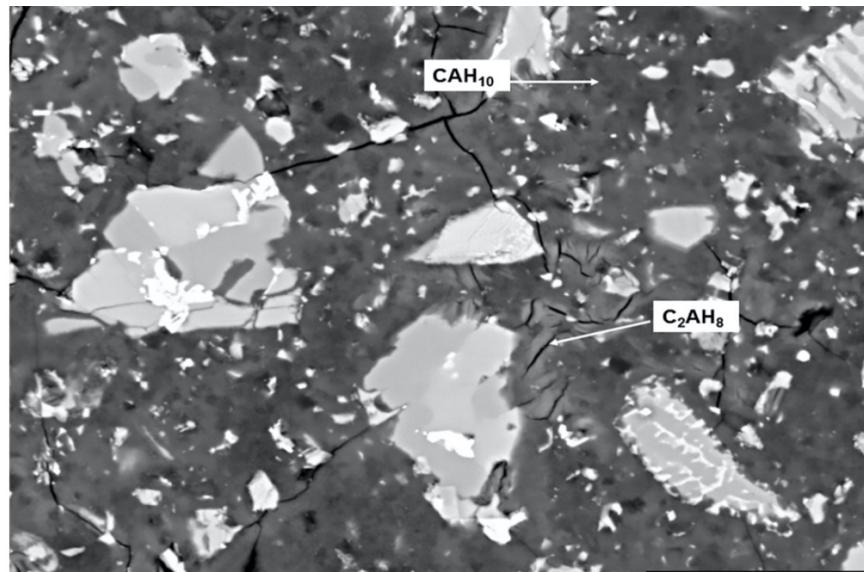
*Slika 18.* AC pasta hidratizirana na 20°C 24 h. Mikorstruktura sadrži uglavnom CAH<sub>10</sub> s nekim udjelom C<sub>2</sub>AH<sub>8</sub> i djelomično reagiranim zrnima CAC-a [21]
