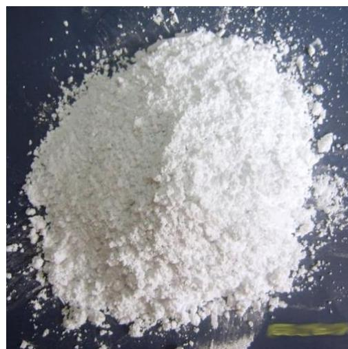
*Slika 2. Aluminatni cement sa visokim udjelom aluminata [11]*
