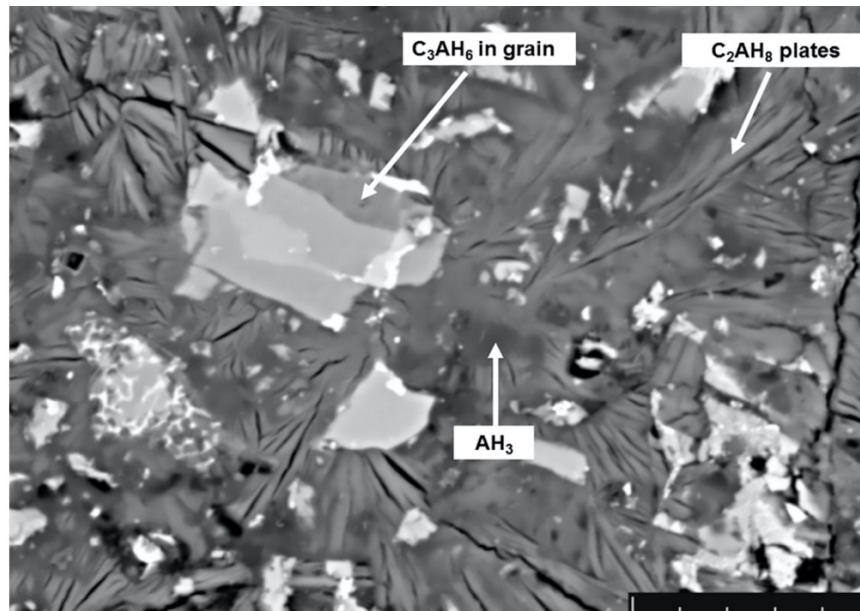
*Slika 19.* CAC pasta sušena 24 h na 38°C, C<sub>2</sub>AH<sub>8</sub> dominira, a uočen je i C<sub>3</sub>AH<sub>6</sub> blizu zrna cementa. AH<sub>3</sub> se može vidjeti u tamnijim sivim područjima između C<sub>2</sub>AH<sub>8</sub> [21]
