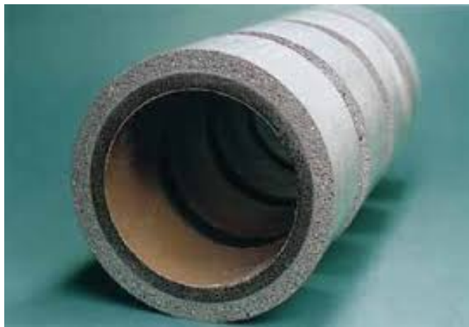
Slika 29. Betonska cijev sa ISTRACAC 40 Inliner [26]
