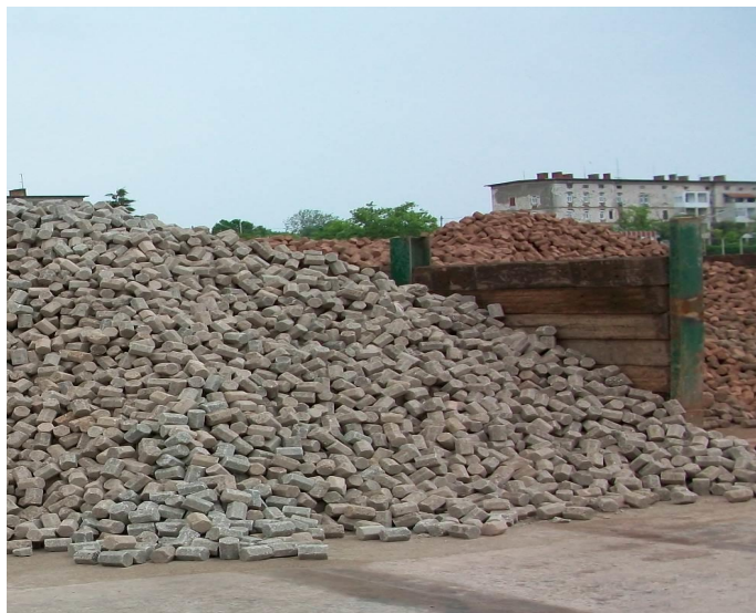
Slika 5. Briketi kalciniranog boksita (lijevo) i crvenog boksita (desno) u Puli [14]
