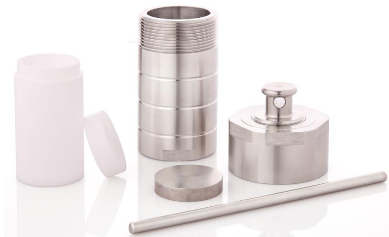
Slika 2. Prikaz autoklava koji se sastoji od posude, diska i poklopca od nehrđajućeg čelika te teflonske posude s poklopcem
