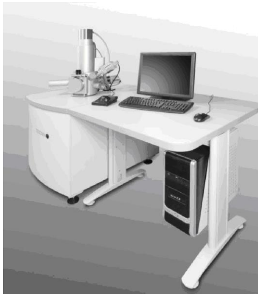
Slika 5. Pretražni elektronski mikroskop (SEM) TescanVega3 SE Easy Probe.
