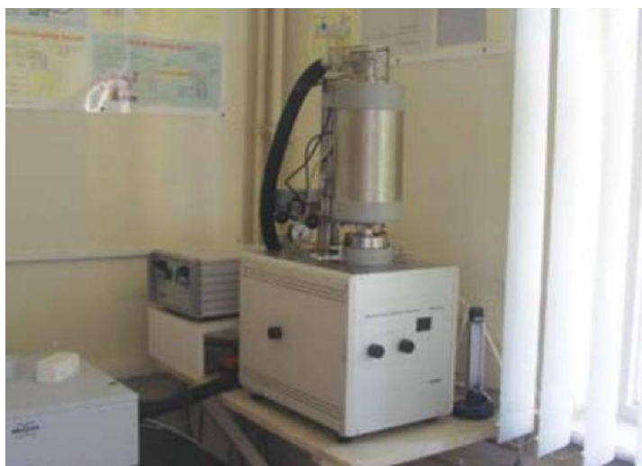
Slika 6. Termogravimetrijski analizator (TGA) NetzschSTA409
