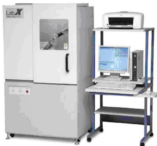
Slika 4. Rendgenski difraktometar Shimadzu XRD 6000
