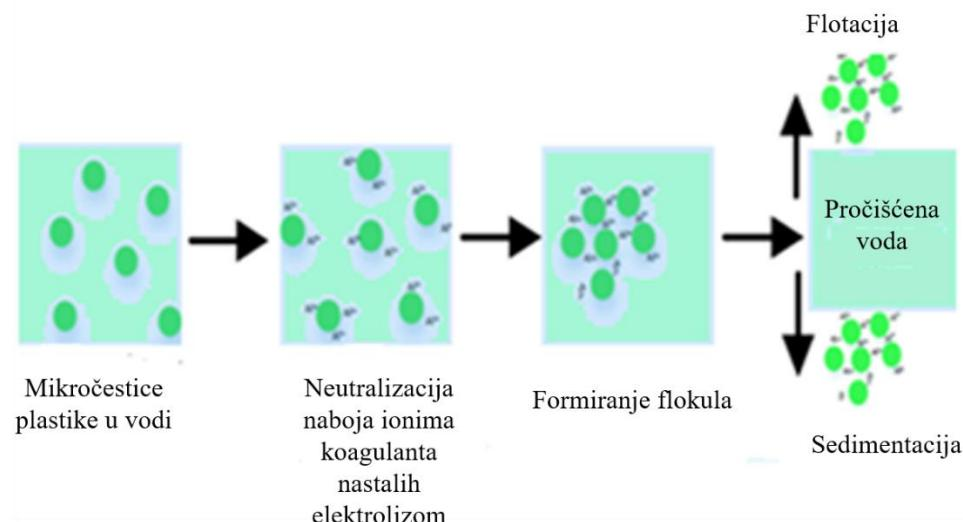
Slika 8. Shematski prikaz mehanizma na kojem se temelji elektrokoagulacija<sup>37</sup>
