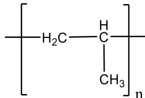
Slika 3. Ponavlјajuća jedinica polipropilena
