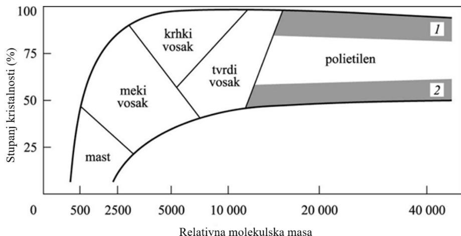
Slika 2. Utjecaj molekulne mase i stupnja kristalnosti na konzistenciju polietilena (1. PE-HD, 2. PE-LD)<sup>17</sup>
