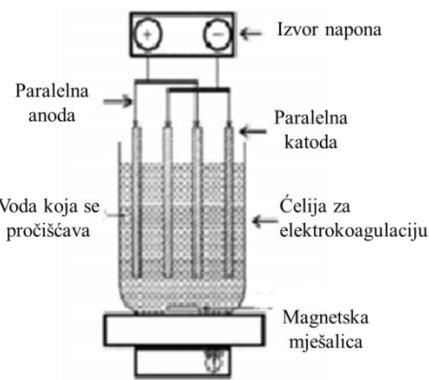
Slika 9. Prikaz elektrokemijskog reaktora s paralelnim monopolarnim elektrodama<sup>48</sup>
