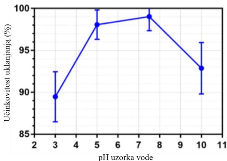
Slika 11. Učinkovitost uklanjanja mikročestica PE nakon 60 minuta
