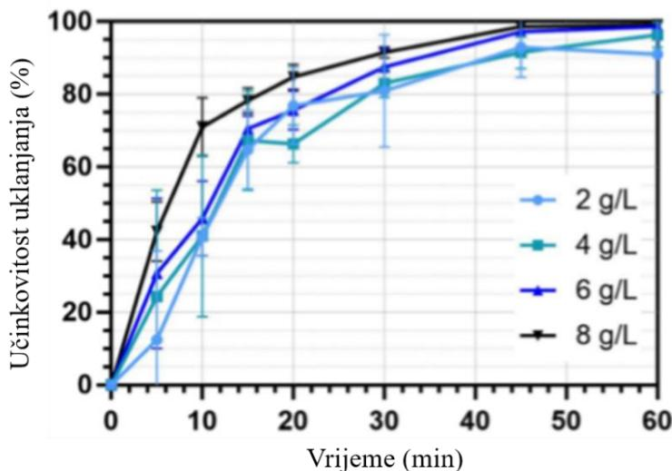
Slika 12. Učinkovitost uklanjanja mikročestica PE pri koncentracijama otopine NaCl od 2 g/l, 4 g/l, 6 g/l i 8 g/l<sup>37</sup>
