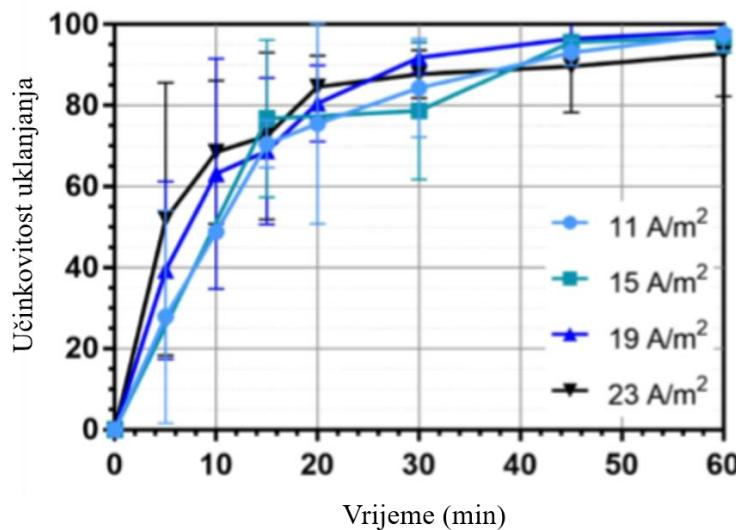
Slika 13. Ovisnost postotka uklonjenih čestica polietilena o vremenu pri 4 različite gustoće struje ( $11 \text{ A/m}^2$ ,  $15 \text{ A/m}^2$ ,  $19 \text{ A/m}^2$  i  $23 \text{ A/m}^2$ )<sup>37</sup>
