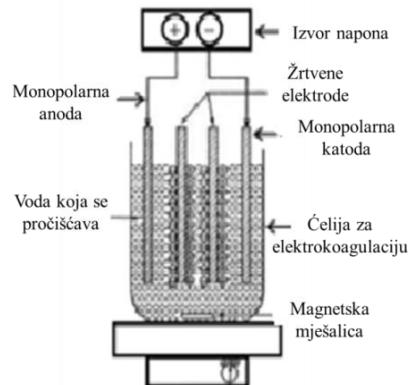
Slika 10. Prikaz elektrokemijskog reaktora s paralelnim bipolarnim elektrodama<sup>48</sup>
