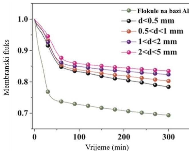
Slika 15. Blokiranje membrane izazvano PE mikročesticama
