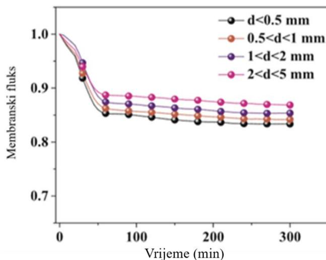
Slika 14. Blokiranje membrane izazvano mikročesticama PE raznih promjera pri pH 7<sup>23</sup>
