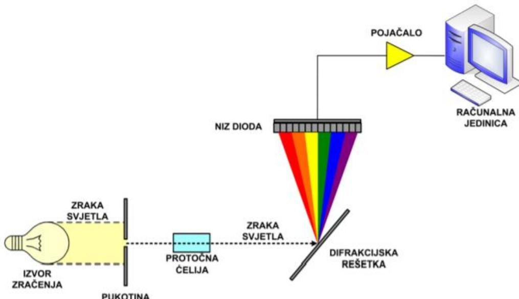
**Slika 6.** Shematski prikaz UV/VIS detekcije s nizom dioda [11]
