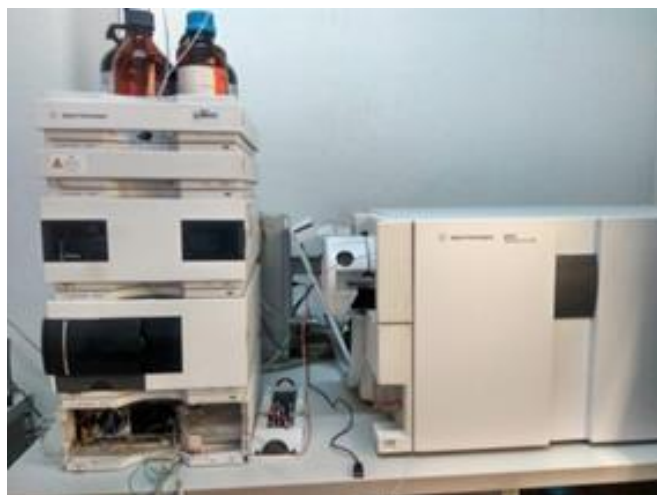
Slika 13. Agilent 1200 s Agilent 6410 trostrukim kvadripolnim analizatorom masa
