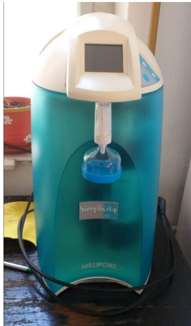
Slika 11. Uređaj za dobivanje MilliQ vode Millipore Simplicity UV sustav
