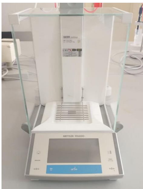
Slika 10. Analitička vaga XA105 DualRange, Mettler Toledo
