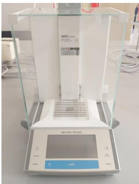
**Slika 10.** Analitička vaga XA105 DualRange, Mettler Toledo
