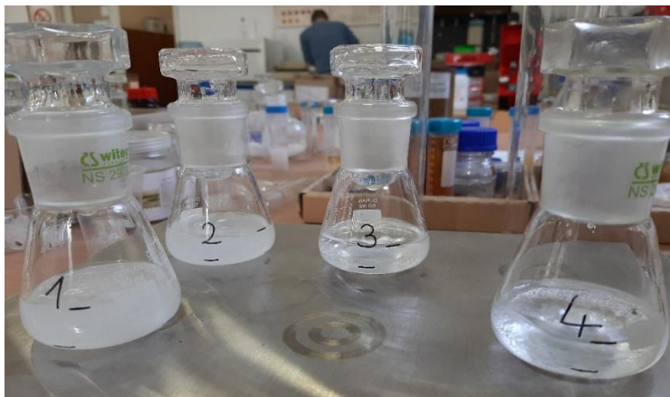
Slika 15. Provedba ekstrakcije na magnetskoj miješalici
