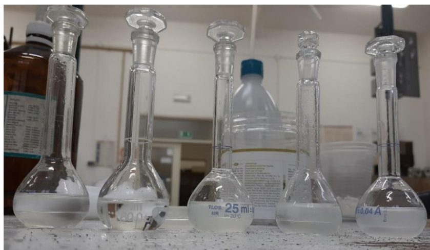
Slika 13. Otopine za vezne linije nakon mućkanja na tresilici
