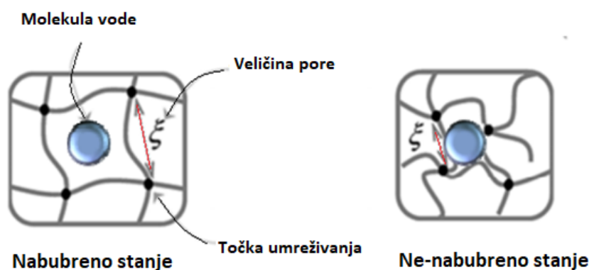
Slika 8. Shematski prikaz veličine pora u nabubrenom i suhom stanju [61]
