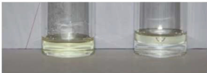
Slika 8. DecA:N 4444 -Cl prije miješanja s vodom (lijevo) i nakon miješanja s vodom (desno)
