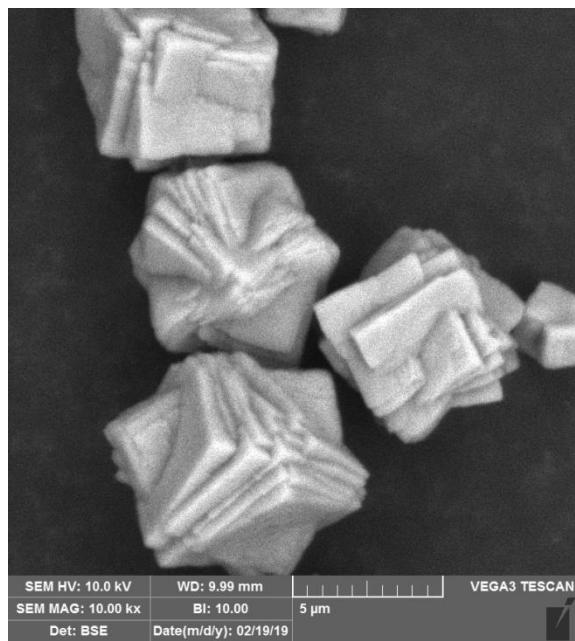
Slika 12. Mikrografija sirovog taloga CK\_3 koprecipitiranog pri 70 °C
