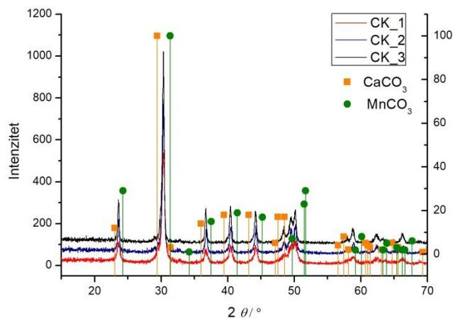
Slika 7. Difraktogrami uzoraka koprecipitiranih pri različitim temperaturama
