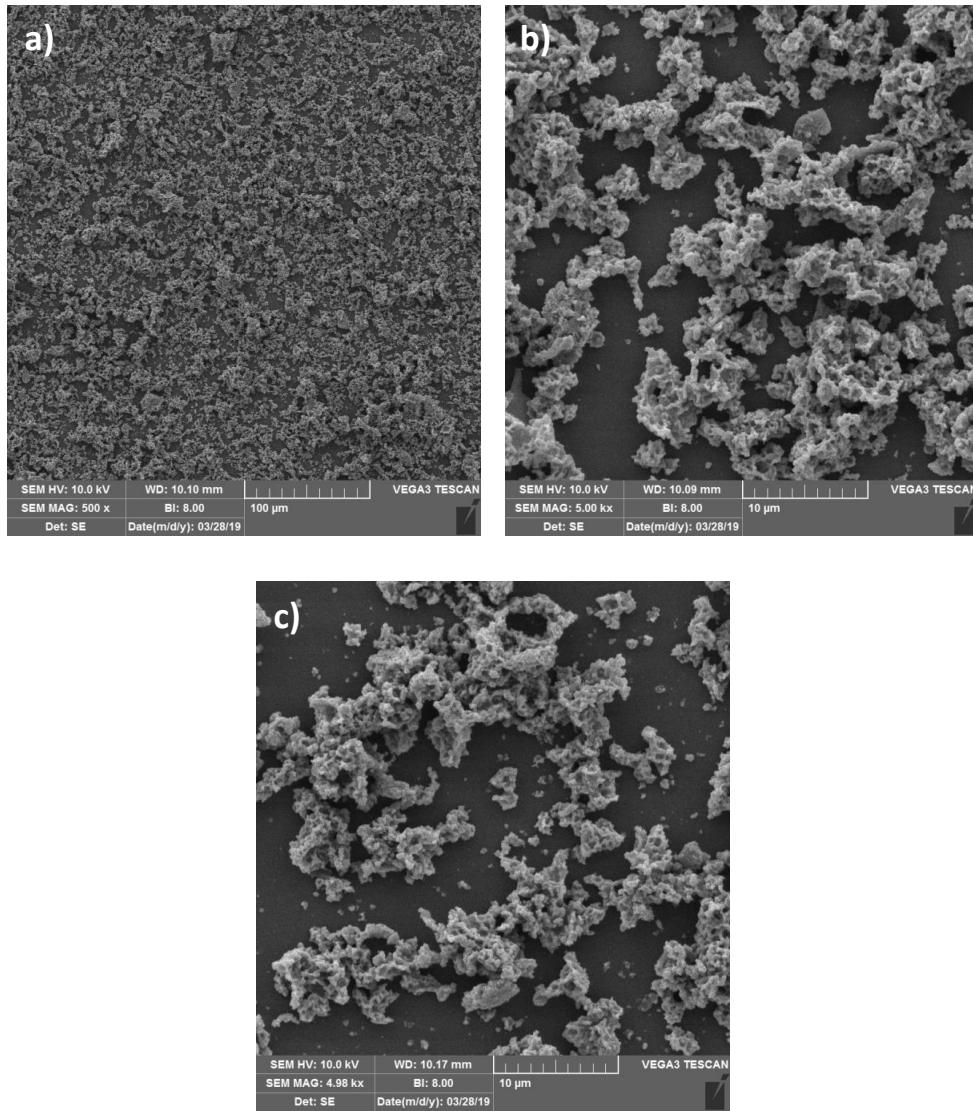
Slika 25. Mikrografije prevlaka uzorka CM1\_900 20 µm, povećanje a) 500 x i b) 5000 x, mikrografije prevlaka uzorka CM1\_900 40 µm, povećanje c) 5000 x
