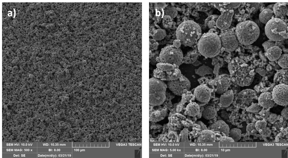
Slika 23. Mikrografije prevlaka uzorka CK\_7\_900 20  $\mu\text{m}$ , povećanje a) 500 x i b) 5000 x
