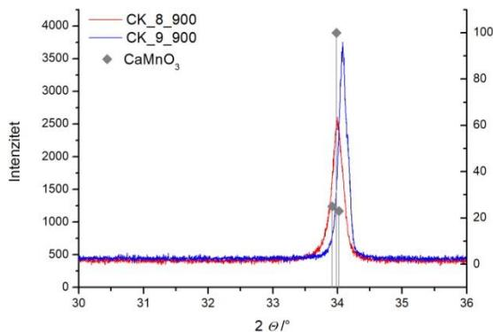
Slika 18. Difraktogrami uzoraka CK\_8 i CK\_9 žarenih pri  $900^\circ\text{C}$
