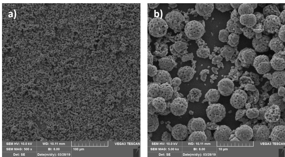
Slika 20. Mikrografije prevlaka uzorka CK\_2\_900 40 µm, povećanje a) 500 x i b) 5000 x
