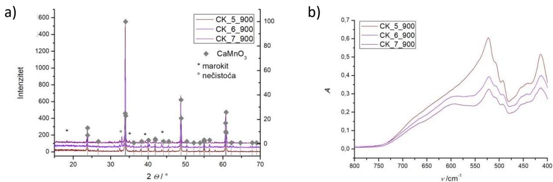
Slika 16. Usporedba a) difraktograma i b) infracrvenih spektara uzoraka CK\_5, CK\_6 i CK\_7 žarenih pri  $900 {}^\circ\text{C}$
