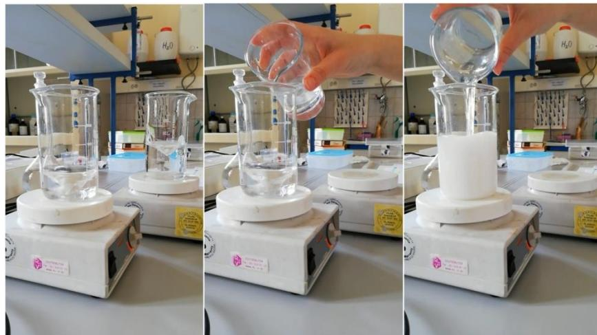
Slika 3. Sinteza metodom koprecipitacije
