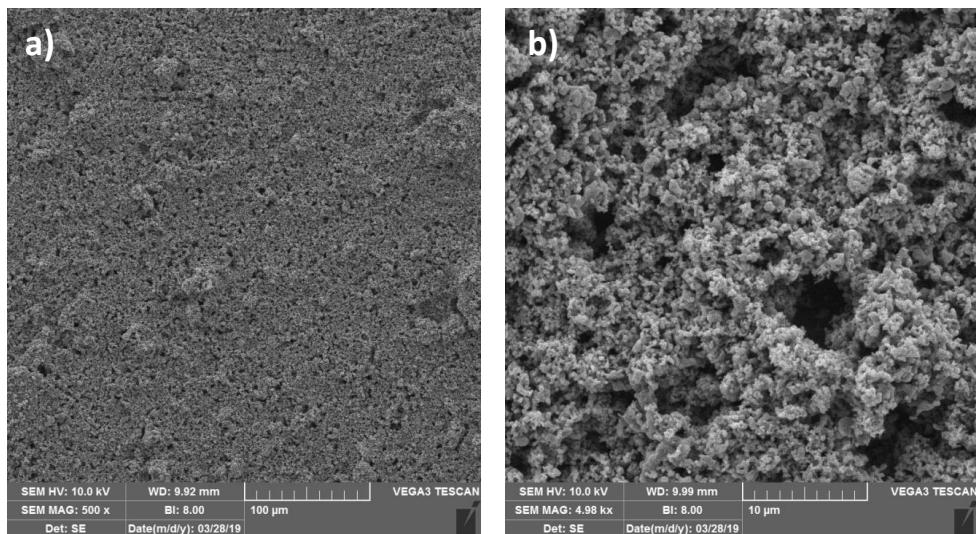
Slika 24. Mikrografije prevlaka uzorka CM7\_900 20  $\mu\text{m}$ , povećanje a) 500 x i b) 5000 x
