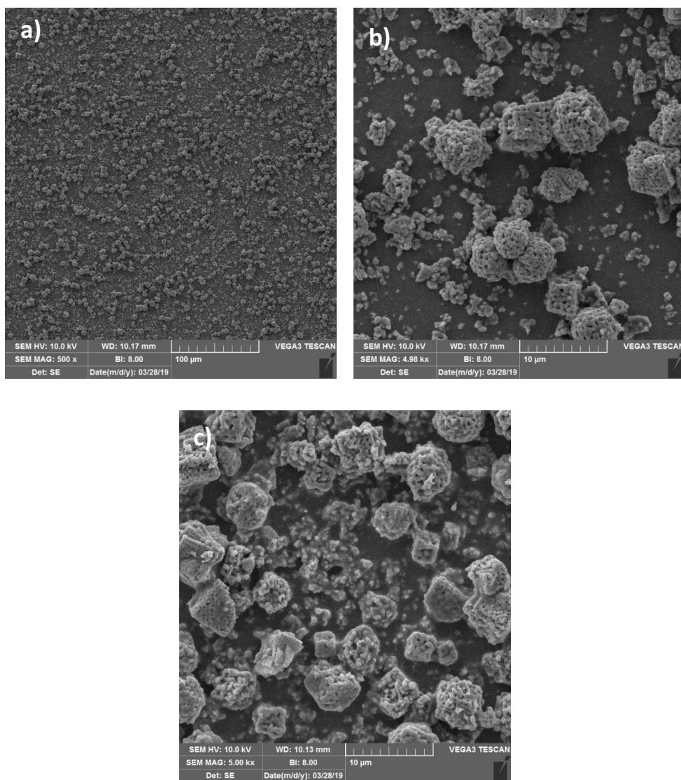
**Slika 21. Mikrografije prevlaka uzorka CK\_3\_900 20 µm, povećanje a) 500 x i b) 5000 x te mikrografija prevlaka uzorka CK\_3\_900 40 µm, povećanje c) 5000 x**
