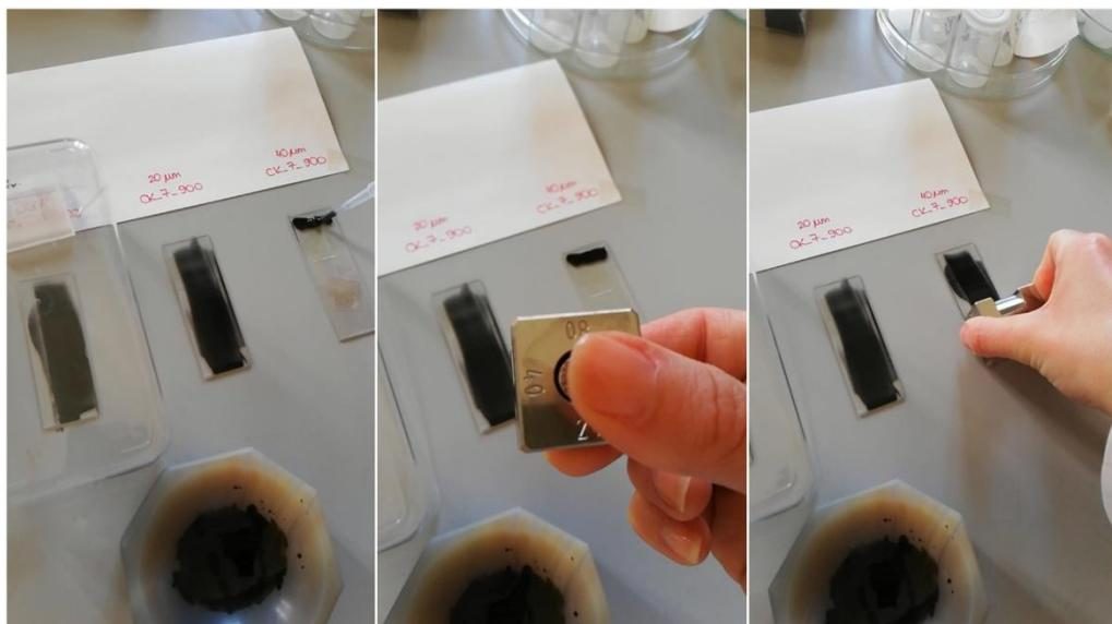
Slika 6. Postupak nanošenja prevlaka rakel-nožem („Doctor bladeom“)
