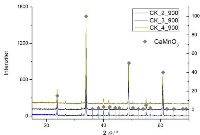
Slika 9. Difraktogrami uzoraka koprecipitiranih pri različitim temperaturama i žarenih pri  $900^\circ\text{C}$
