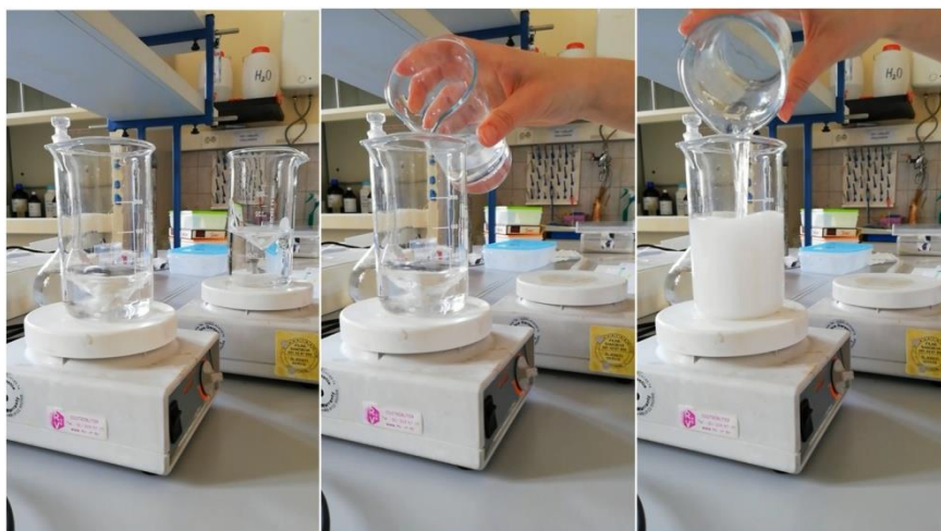
Slika 3. Sinteza metodom koprecipitacije
