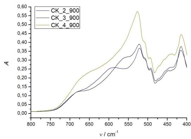
Slika 10. Infracrveni spektri uzoraka koprecipitiranih pri različitim temperaturama i žarenih pri  $900^\circ\text{C}$
