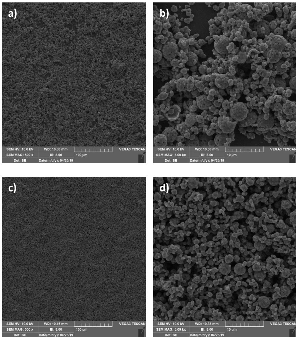
Slika 19. Mikrografije prevlaka debljine 40 µm uzorka CK\_1\_900, povećanje a) 500 x, b) 5000 x i uzorka CK\_4\_900, povećanje c) 500 x i d) 5000 x
