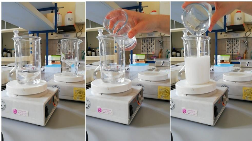
Slika 3. Sinteza metodom koprecipitacije
