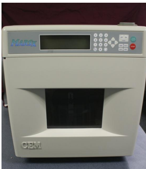
Slika 12. Uređaj za mikrovalnu ekstrakciju [7]
