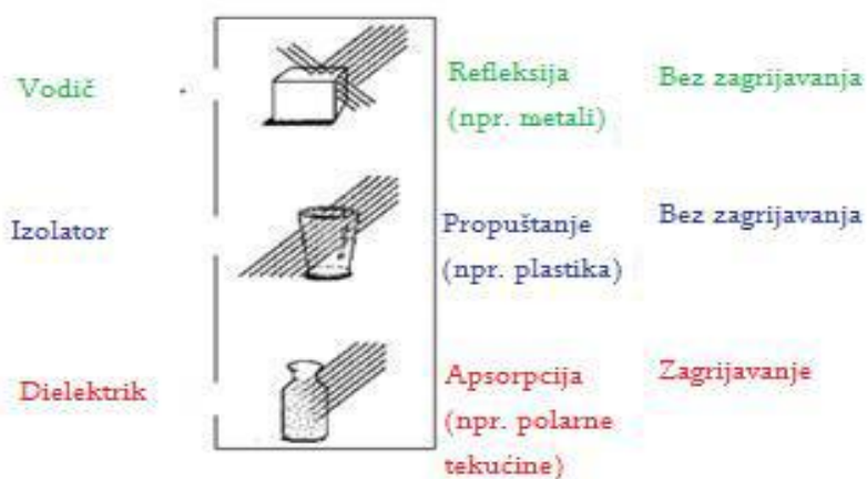
Slika 10. Djelovanje mikrovalova na različite materijale [7]
