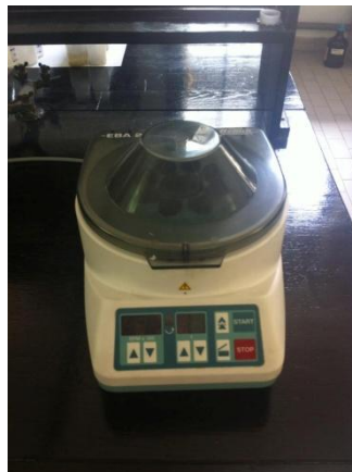
Slika 19. Centrifuga marke Hettich Zentifugen, Eba 20, Njemačka [12]
