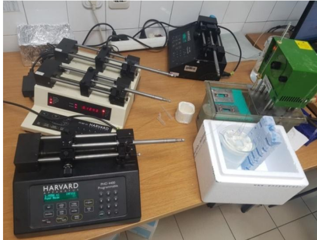
Slika 10. Aparatura za sintezu biodizela u mikoreaktoru
