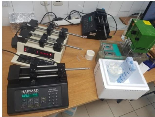
Slika 10. Aparatura za sintezu biodizela u mikroreaktoru
