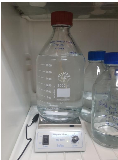
Slika 11. Dijaliza taloga u fosfatnom puferu
