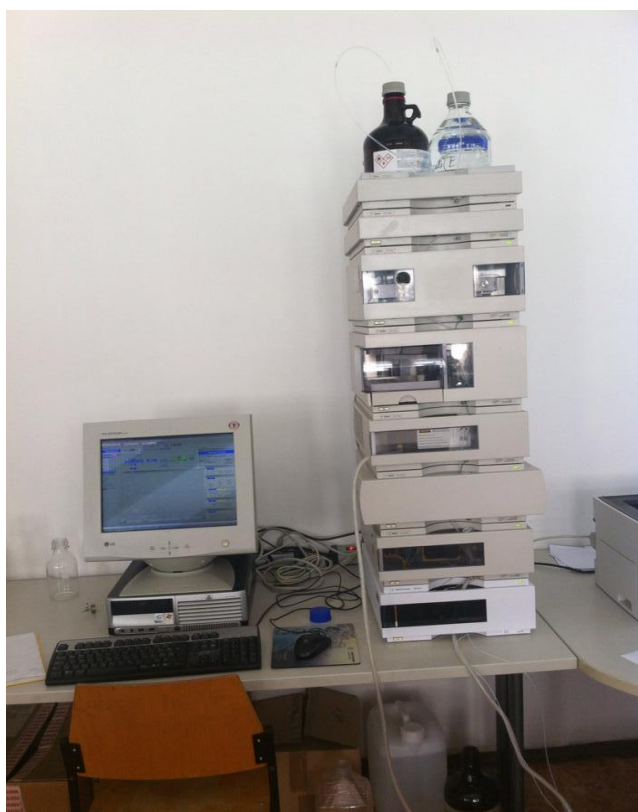
Slika 18. Kromatografski sustav Agilent 1100 (Agilent Tehnologies, USA)
